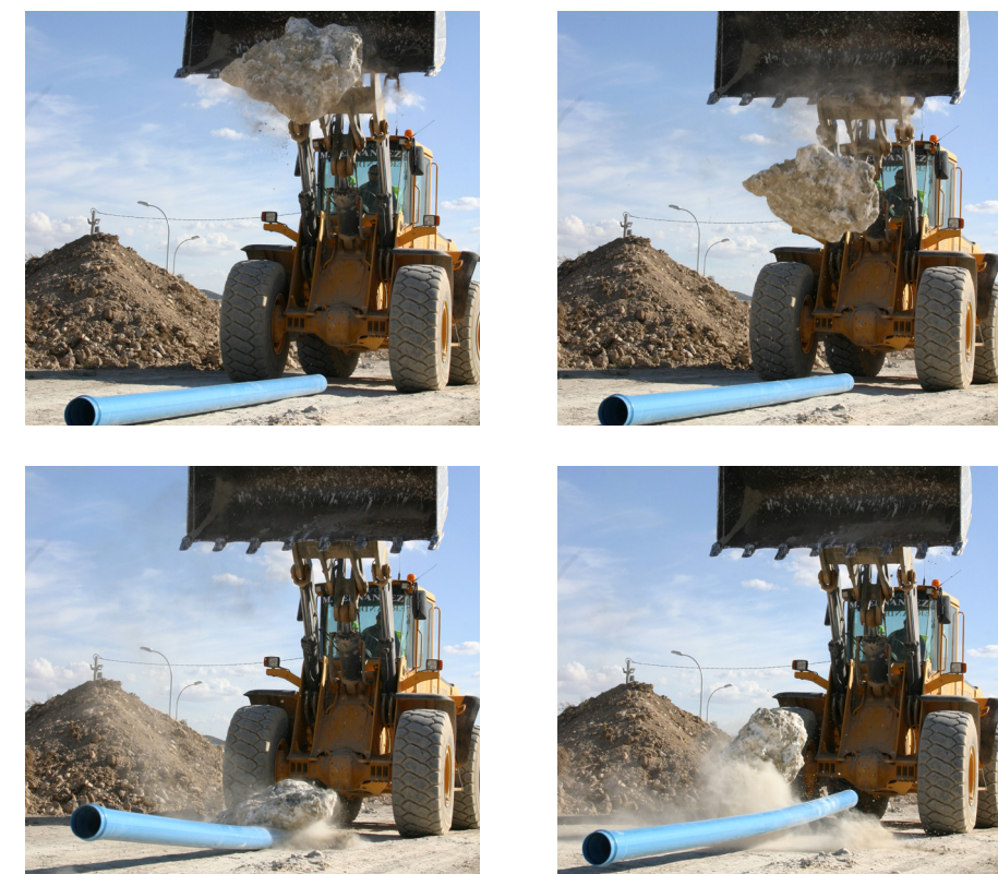
После удара камнем весом 500 кг, сброшенным с высоты 3 м, на трубе ТОМ не осталось никаких повреждений.
