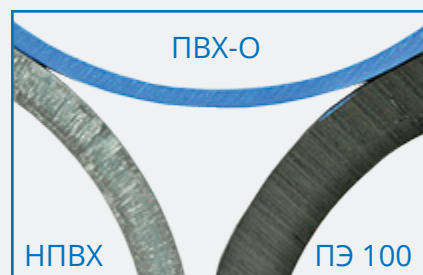
Трубы (диаметр 225 мм, PN 16), изготовленные из разных пластиков.
